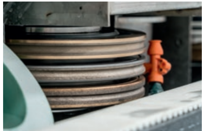
最佳的灵活性归功于多达4个可用磨轮的配置, 以便于快速改变玻璃的厚度
