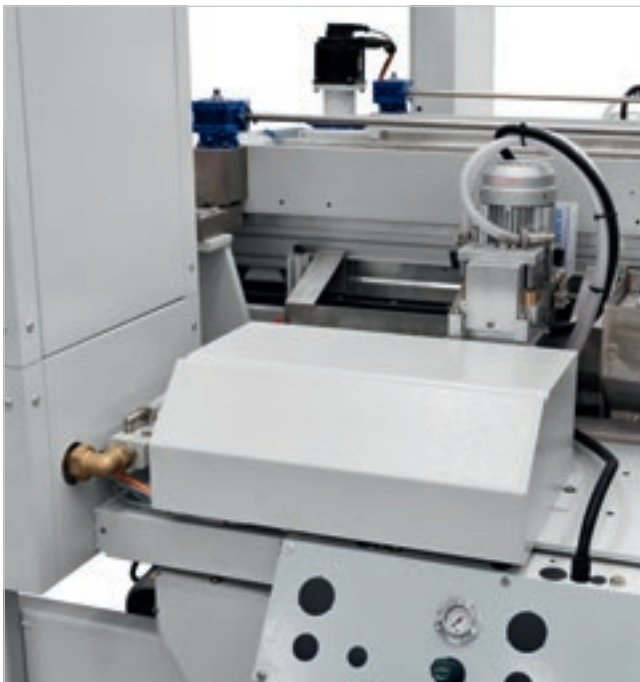
加工速度可达10米/分钟 用于磨倒棱角和圆角的电动圆角切割磨头, 速度可达10米/分钟
